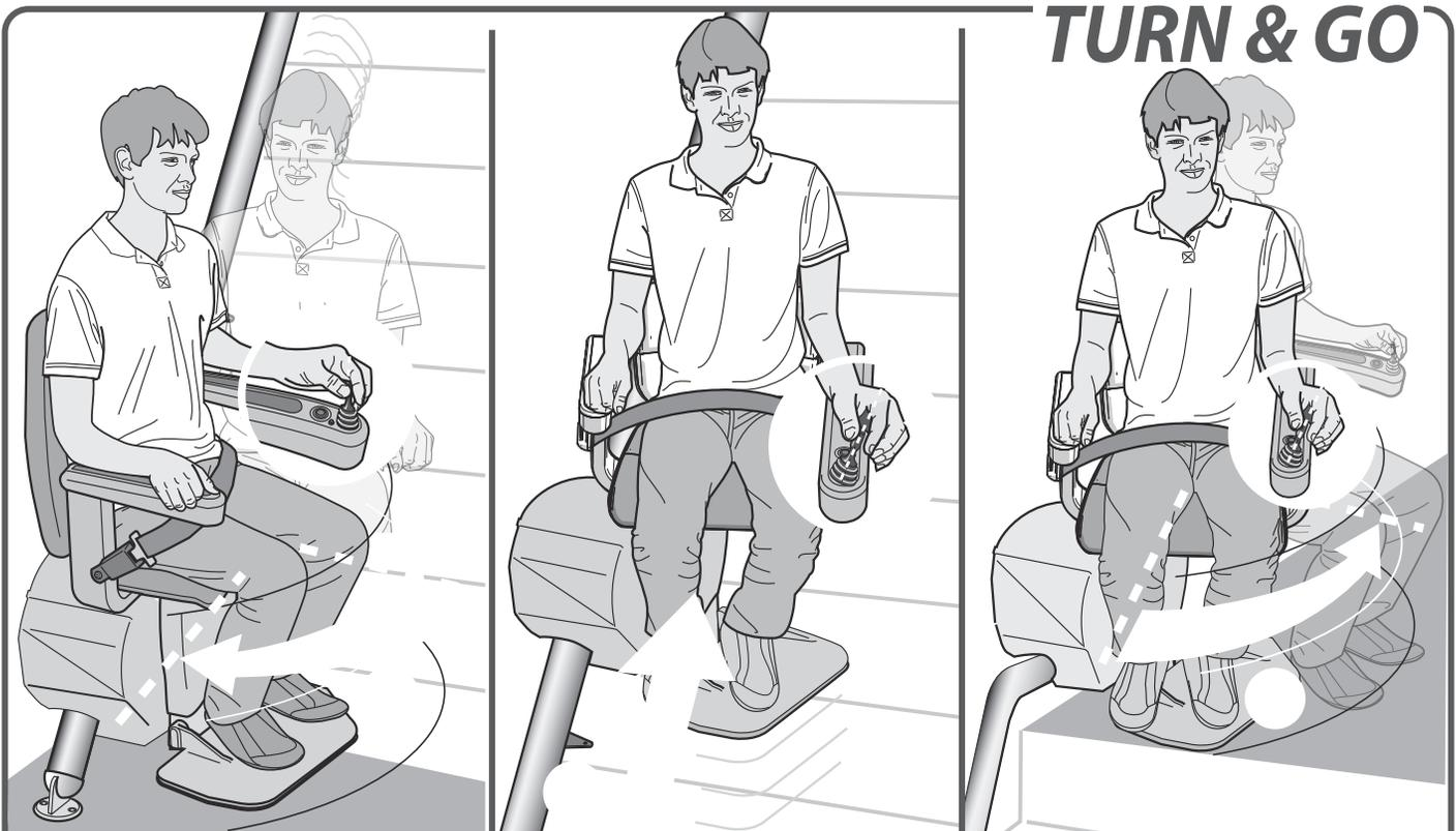
Mit der Option TURN & GO drehen Sie den Sitz so, dass Sie mit dem Rücken zur Treppe nach oben oder unten fahren {B}. Halten Sie dazu den Joystick am Schienenanfang und -ende {A und C} in der gewünschten Fahrtrichtung gedrückt.
